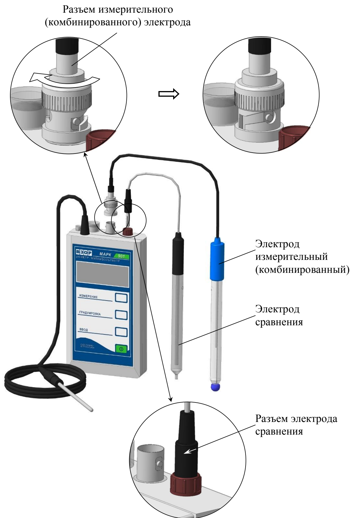
Рисунок 2.4 – Установка электродов
