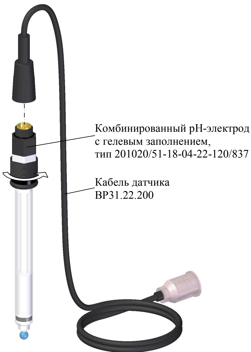
Рисунок 2.3 – Подсоединение кабеля датчика к электроду
